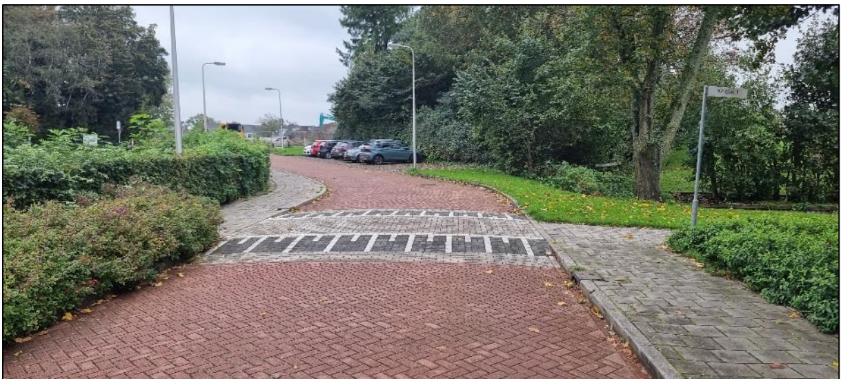
Figuur 4.5: Voorbeeld drempel in een 30 km/uur-zone, incl. doortrekken trottoir (toegankelijkheid)
