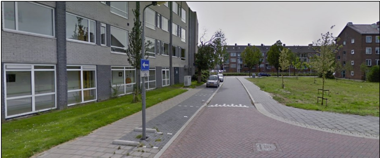
Figuur 4.11: Een voorbeeld van langsparkeren met een verhoogde schuine band voor toegankelijkheid bij een plateau
